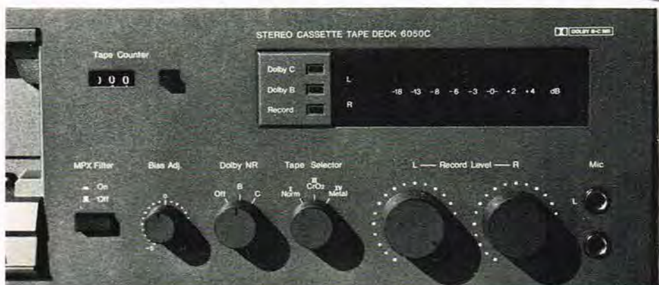
Her ses højre del af forpladen på model 6050 C. Til venstre på denne er der en bias finjustering, og det skal understreges at den har stor værdi, især ved maskiner med Dolby C, der er mere følsomme for ukorrekte biasindstillinger end konventionelle kassetebåndoptagere.
