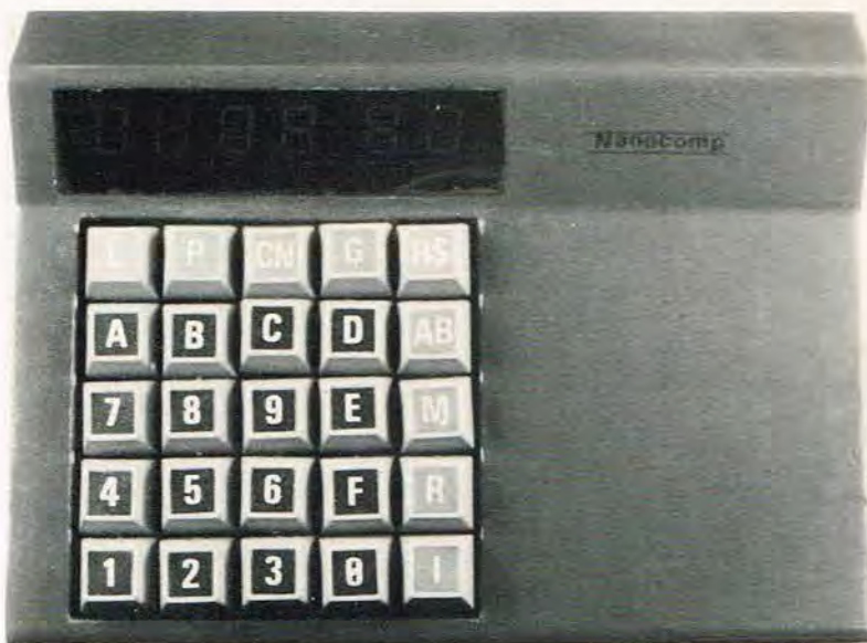
Billede af tastatur og display på et udviklingssæt med en microprocessor. Programmeringen foregår i 16-tal systemet (=det HEXADECIMALE talsystem.) Der tælles: 0, 1, 2, ..... 9, A, B, C, D, E, F, 10, 11, ..... 1E, 1F, 20 .....
