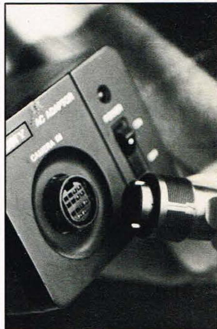
Lynkoblingen på det 14-polede K-stik sikrer hurtig og præcis tilslutning - her til strømfor- syningen. Via denne tilslutning overføres alle informationer, - billede, lyd og pausestyring, og så naturligvis strøm til kameraet.
