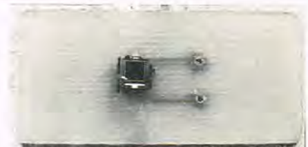
Fotodioden på det lille print. Printet saves ud af det store hovedprint.
