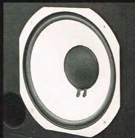
Basenheden er på 10" med keramisk magnet og kantviklet svingspole. Systemet, hvori enheden indgår, kan forarbejde impulser ned til ca. 32 Hz med stor præcision og rimelig lydtryksformåen.
