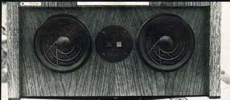
Variovent er DynAudio's betegnelse for disse ventiler, som sigter på at sikre bedst tænkelig impulsforarbejdning og reduktion af forvrængningen omkring egenresonans frekvensen.
