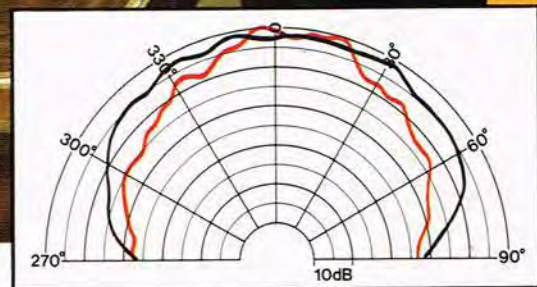
Polardiagram af P500's patenterede CD-kobling. Rød: 10 kHz - Sort: 4 kHz.
