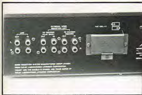
På bagsiden har AL-90 tilslutning for bl.a. en extern støjrduktionsenhed. De to AA-batterier der er plads til i batterikammeret, holder strøm til memory'en i tilfælde af strømsvigt på det offentlige net.
