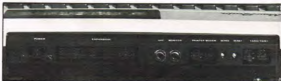
Stikmuligheder på NewBrain. Man lægger mærke til de to kassetteudgange, udgang til monitor og tv, to V24 porte og den store expansion-port.
