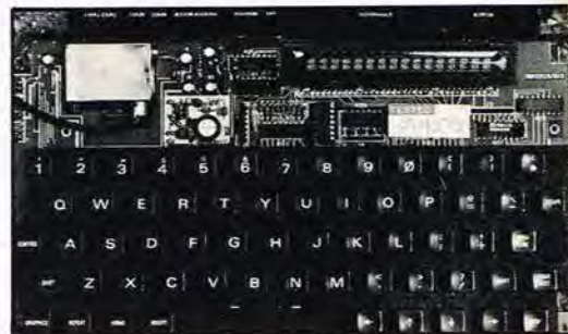
Tastatur på NewBrain. Bemærk 14-segment-lysdisplay øverst.
