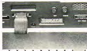
Kablet der forbinder tastatur og datamat på OSBORNE 1
