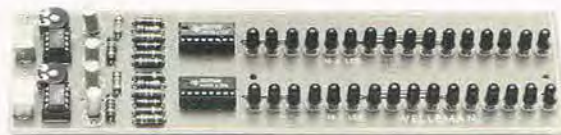
K 1798, stereo LED VU-meter med forstærkerindgang . . . . . kr. 236,00
