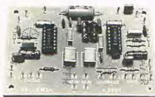
K 2581, stereo volumen og tonekontrol DC reguleret - indgangs-impedans: 1 Kohm. Forstærkning: 1 - Forvrængning: typ. 0,2%. Frekvensgang: 20 Hz til 20 KHz (-1 dB). Basregulering: -17 til +17 dB. Diskantregulering: -17 til +17 dB. Fysiologisk volumekontrol. . . . . kr. 169,50
