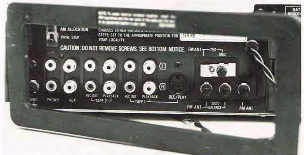
Gennem den store AM-loop antenne, der let påmonteres, ses de mange tilslutningsmuligheder bag på SA-323 receiveren.
