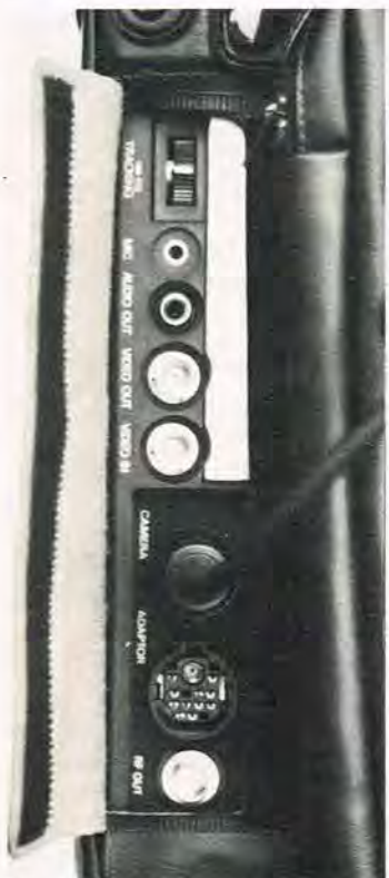
Her ses tilslutningerne på optagerens venstre side. Kamerastykket monteres med en omløbering, men det rigtige havde været en lynkobling.
