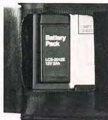
Et tryk på "BATT. EJECT", og batteriet kommer glidende ud.
