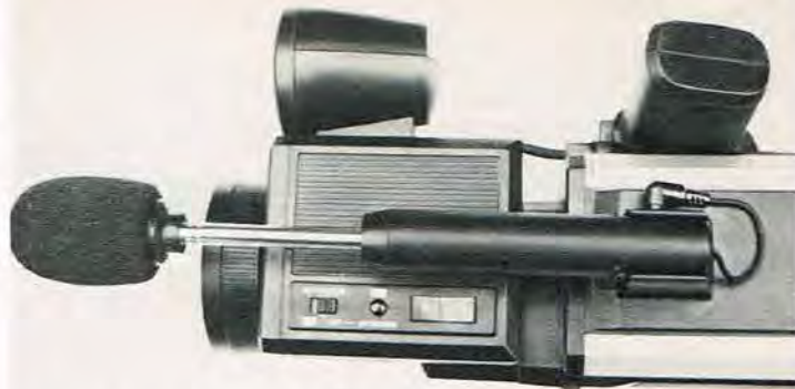
Panasonic kameraet WVP - 50 set ovenfra. Her sidder fingerstyringen til motor-zoom'en samt auto-focus tænd/sluk.
