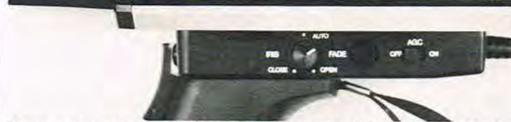
På kameraets venstre side findes blændejustering, fade-knap, omskifter for inden- og udendørs belysning, samt aut. indstilling af hvidbalancen.
