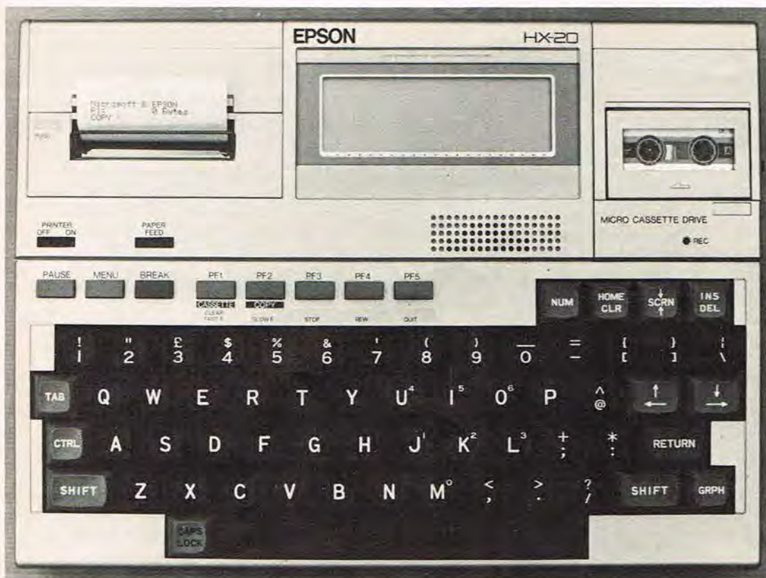
EPSON HX-20. Bemærk printer, display og indbygget kassettebåndoptager.
