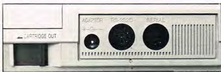
Tilslutningsbøsninger for netadaptor, floppy-disk og RS232C for EPSON HX-20.
