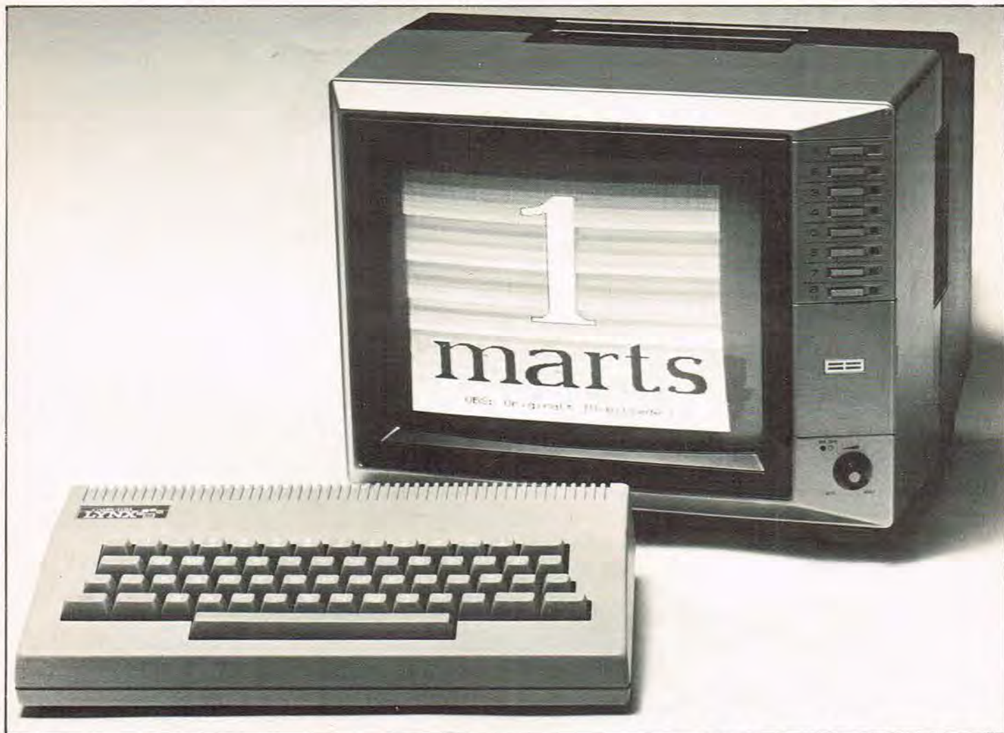
Lynx datamaten med farveskærm. Bemærk det rigtige skrivemaskinetastatur.
