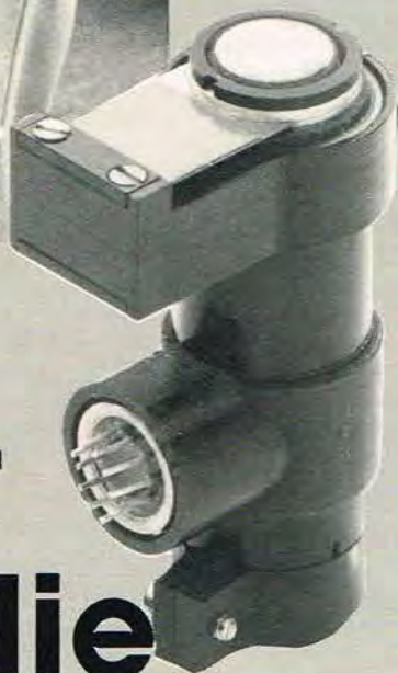
Dette er laser-enheden fra en Philips Compact Disc.
