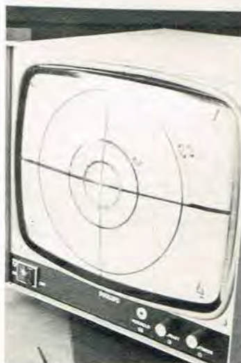
Laseren afprøves på denne TV-skærm med "indbygget skydeskive".
