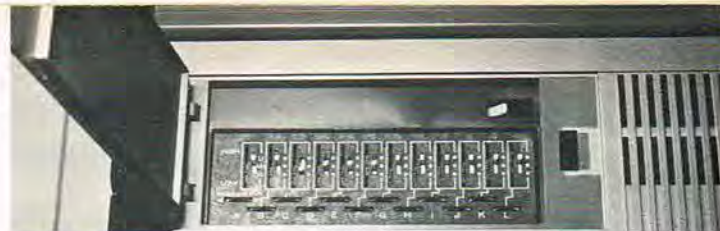
Tunerens kanalindstilling gemmer sig under en klap i kabinetets top.
