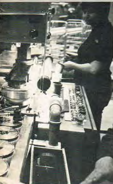
Der klæbes ikke etiketter på CD-pladerne. Teksten trykkes på med hurtigt tørrende maling. Dette er maskinen hos PolyGram, der foretager denne proces.
