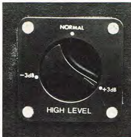
Diskanten kan via en regulator på kabinetets bagside justeres til passende styrke.
