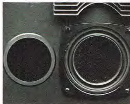
Mellemtonen varetages af en 4 1/2" enhed monteret med skumplade.
