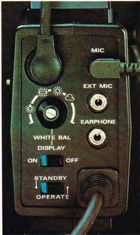
Kameraets bageste del med bl.a. hvidbalance indstillingen og den strømbesparende stand-by omskifter.
