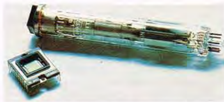
Forskellen i størrelse mellem det normale farverør og MOS-billedsensoren er jo tydelig.
