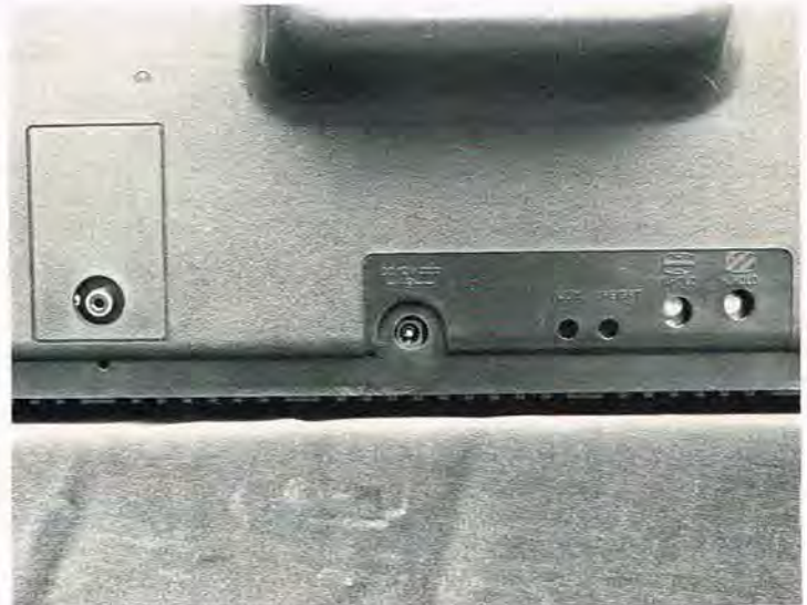
Microbee monitoren med videoindgang og 12V udgang.
