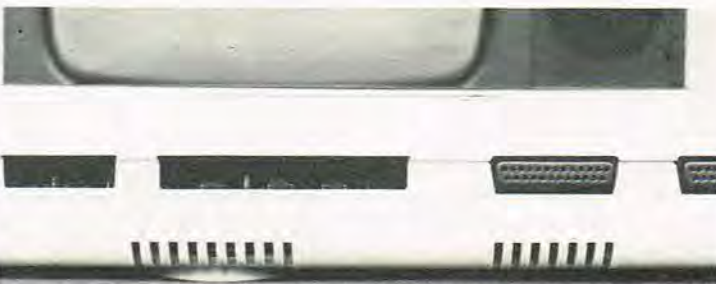
Den serielle RS232 udgang og den parallelle 8-bit udgang på Microbee.
