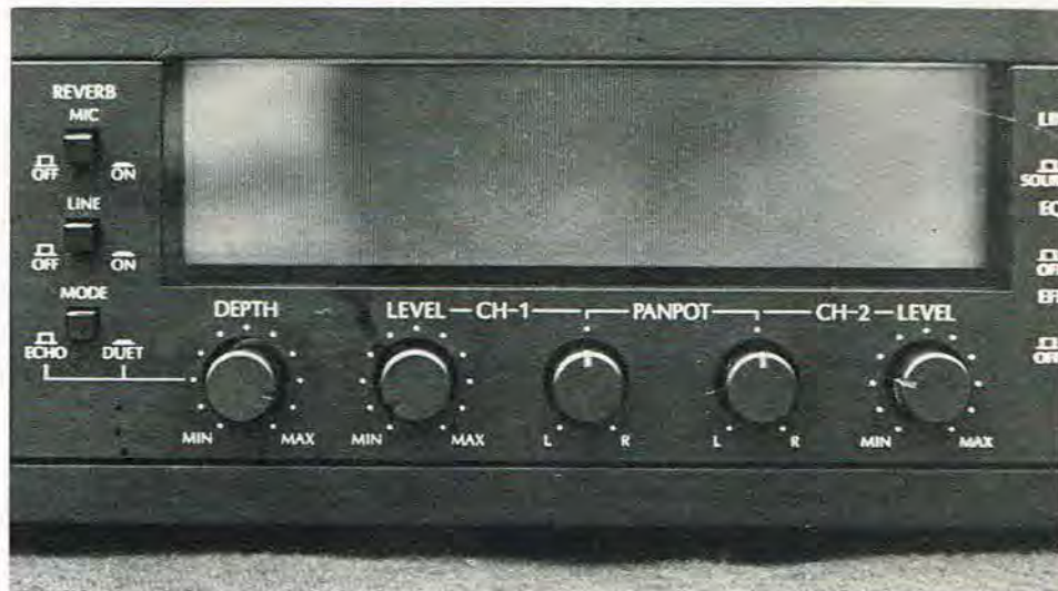
Begge indputs har en individuel styrkeregeringsmulighed, således at man i forbindelse med den aktuelle optagelse kan tilpasse outputtet. Begge inputs har også panpotregulering, hvis funktion beskrives i artiklen!
