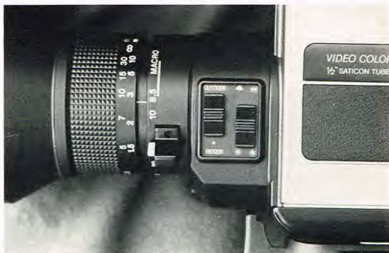
Nærbillede af Blaupunkt TVC-302 videokamera. De to skydere midt i billedet, bruges til indstilling af hvidbalancen. Kameraet er forsynet med et 1/2" Saticon videorør, der giver billeder med god farvemætning, samtidig med at det er meget lysfølsomt.
