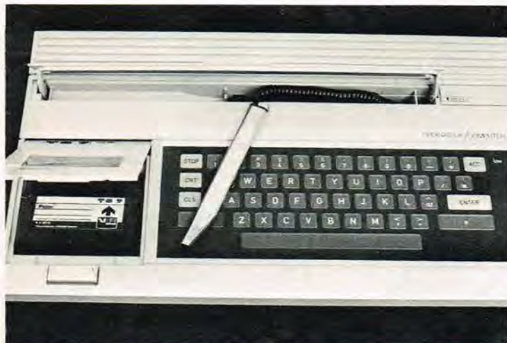
Den indbyggede lyspen giver mulighed for direkte kommunikation med skærmen uden brug af tastaturet.
