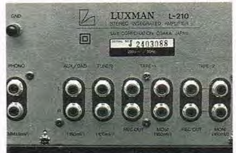
Forstærkeren L-210 har naturligvis alle nødvendige tilslutninger bagpå i form af phonostik. En CD-spiller kan tilsluttes AUX indg.
