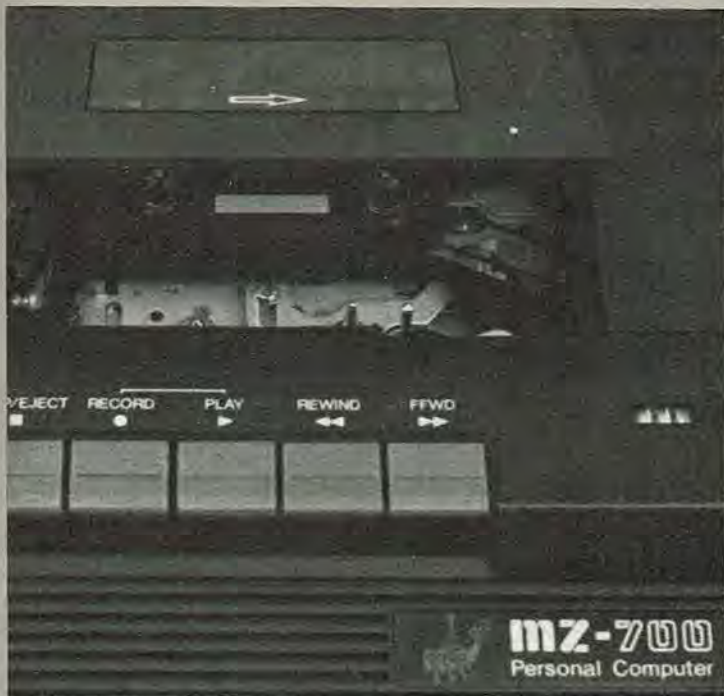
Kassettedelen lever ikke helt op til Sharp's standard, bl.a. er der ikke automatisk stop ved båndudløb.
