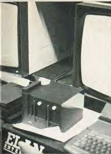
◀ ELAN-computeren ses her sammen med de perifere enheder, som forbindes indbyrdes uden det sædvanlige opbud af 'lakridskabler'. En særdeles driftssikker og pålidelig forbindelse opnås på denne måde.
