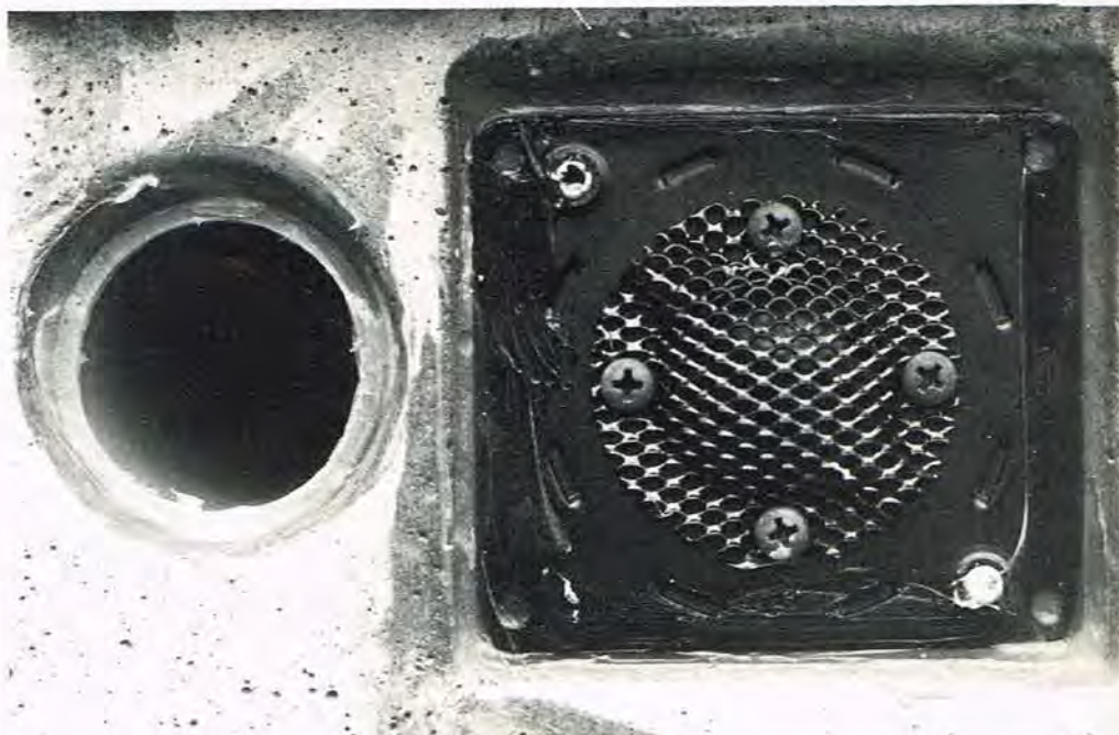
De større modeller i Raunafabrikens højtalerprogram er udført efter transmissionsline princippet, men det system kræver jo plads til de nødvendige kanaler, og derfor har Rauna valgt at konstruere den mindre 'Tyr' som et ægte basrefleksystem.
