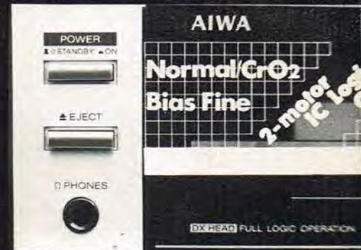
F 330 er en maskine med DX-tonehoved, 2-motorer og fuld logisk kontrol, hvilket fabrikken også tydeligt fortæller 'ved skiltning'.
