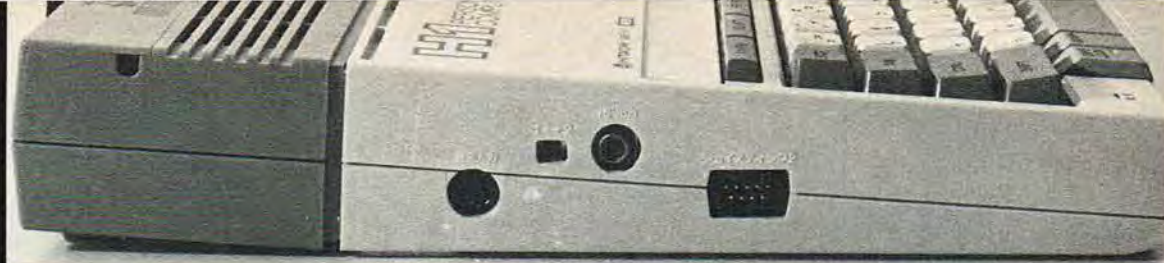
Fra venstre ses bøsninger for strømforsyning, TV-udgang og joystick.
