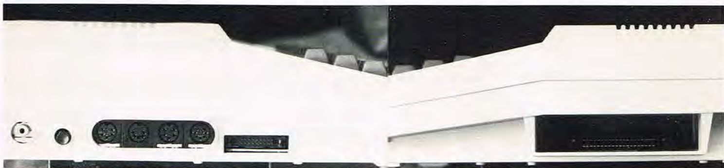
Dragon 64 er udstyret med alle de velkendte tilslutninger som de kendes fra 32'eren. Det vil sige TV, RGB-monitor, 2 Joy-sticks, kassetbandoptager med fjernbetjeningsmulighed samt Centronics-interface og game port. Yderligere er 64'eren udstyret med en RS-232 port som ikke findes på forgængeren.
