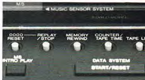
De små hvide knapper på F-770 der ses her, står i forbindelse med den elektroniske båndtæller, og bruges ved valg af Tape-time/tæller, reset, memory m.v.
