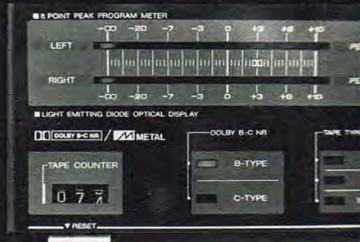
Nærbillede af AD-F330 der bl.a. viser det 8-punkts LED-display. I modsætning til den større F-770, har F-330 mekaniske båndtæller, og ikke den dyrere elektroniske type.
