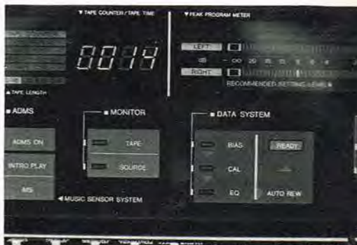
På kun 16 sekunder måles der en mængde gange på det ilagte bånd, og 770'eren indstilles automatisk til optimale værdier for Bias, EQ og følsomhed. Dette markeres på det viste display mærket Data system.
