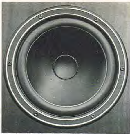
Bestykningen i denne DynAudio er velvalgt, idet bassen varetages af en 8" skumophængt enhed med Polymer/Magnesium -silikat-membran.
