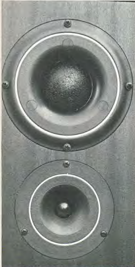
Filterteknisk er der tale om et 6 dB pr. oktav filter, hvilket stiller langt større krav til specielt mellemtoner- og diskantenhederne, der ses her.
