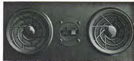
Kabinettet er udført efter DynAudio's kombination af en kort transmissionslinie og varioventprincippet, - en slags akustisk dæmpet ventil hvoraf MSP 300 har 2 stk. bag på.
