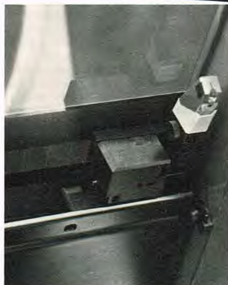
Nærbillede af pick-up enheden der er placeret i pladespillerens støvlåg.
