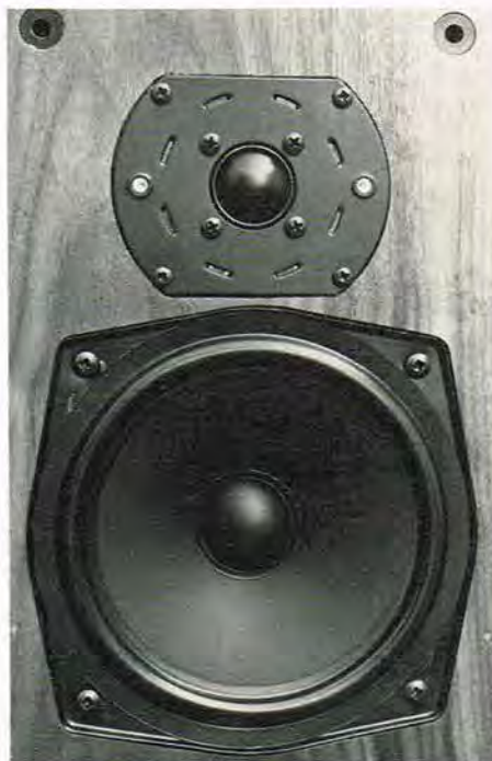
Begge de to enheders membraner er udført i et plastmateriale, og centerdomen på den aktive basdriver, er her lavet af blødt PVC for at undgå peaks i frekvenskurven.
