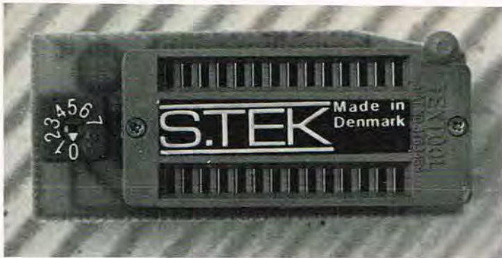
Ekspansionsmodulet til Softy, giver mulighed for større EPROM-kredse.
