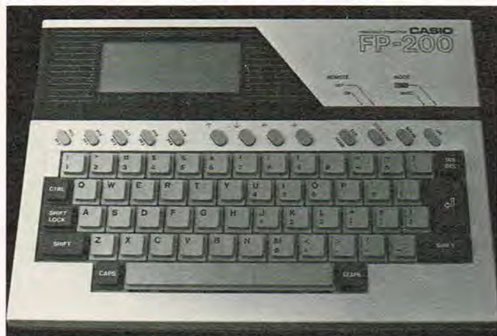
Casio FP-200. Bemærk det store flydende krystaldisplay med 8 linier a' 20 tegn.
