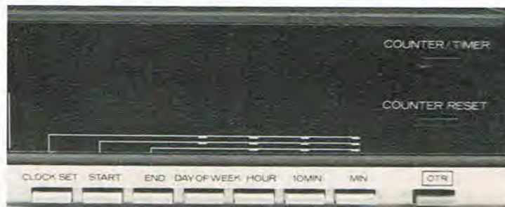
Med den nederste række knapper indstilles ur og timer. Proceduren er ikke særlig svær. Yderst til højre ses OTR-knappen, der giver en meget forenklet timerindstilling. Så er man fri for besværlige indstillinger hvis man gerne vil på hovedet i seng, eller pludselig skal forlade hjemmet.
