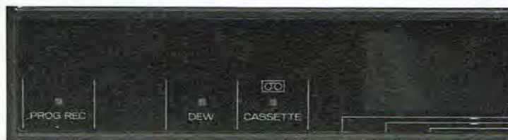
Lige under kassettelugen sidder indikatorerne for 'bånd inde', og fugt. Prog. Rec. er også flyttet herhen, så den er lidt af vejen.
