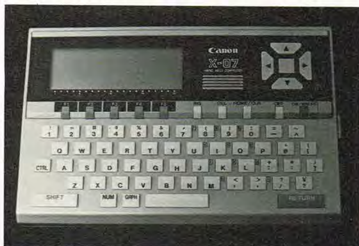
Canon X-07. Bemærk det flydende krystal display med 4 linier a' 20 tegn.
