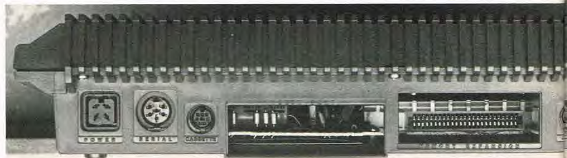
Alle de nødvendige tilslutninger er til stede, bortset fra en Centronics-port, som af en eller anden grund ignoreres totalt af Commodore. Hvilke muligheder user-porten rummer, vides endnu ikke, men mon ikke den indeholder en eller anden form for RS-232?
