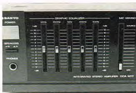
Den grafiske equalizer på forstærkeren DCA-M17 har fem forskellige frekvensområder.
