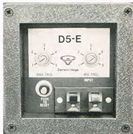
Bagsideterminalen med bl.a. reguleringerne for mellemtone og diskant.
