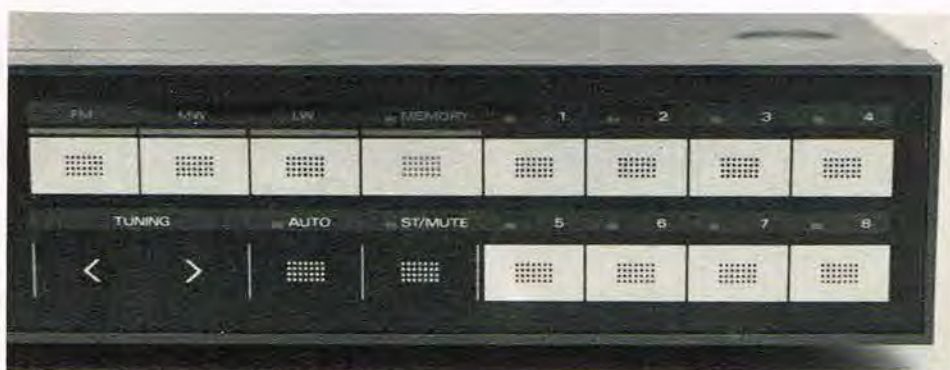
Nærbillede af tunerens betjeningsdel. Der er tre bølgeområder: FM, MB, LB, og der kan forudindstilles 8 FM og 8 AM stationer. Indstilling af frekvensen kan foretages både manuelt og automatisk.
