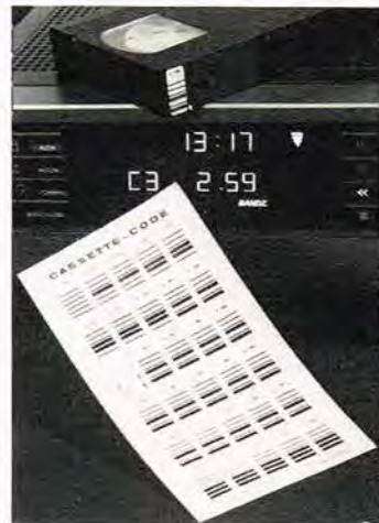
Man kan slippe for at indkode kassetypen ved istedet at sætte en lille selvklæbende kode-etiket på kassetens ryg, - smart idé.
