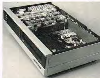
Modulopbygget og servicevenligt chassis, som på Video 2000, der fortsætter uændret.
