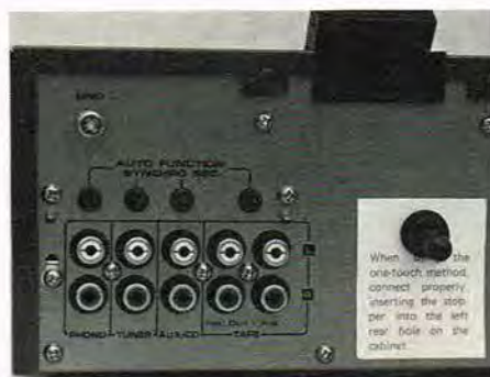
Over de normale phonostik på forstærkerens bagside ses Synchro stikkene hvor igennem de enkelte enheder 'taler' sammen.
