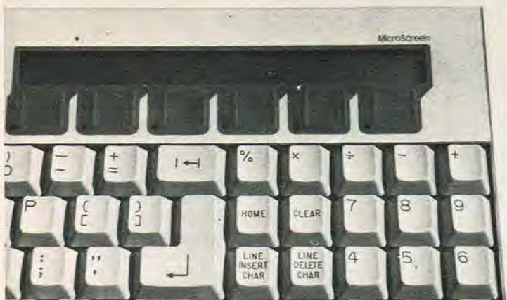
Tastaturet er en lille enhed for sig, som er udstyret med en selvstændig processor, en ur- og kalenderkreds samt en programmerbar lydgenerator. Tastaturet har 96 taster som alle er frit programmerbare.
