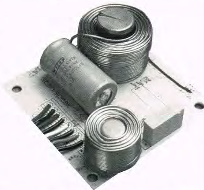
Det anvendte filter er et rent 6 dB/oktav seriefilter, hvis overførelseteknik muliggør fasekorrekt reproduktion. Kvaliteten er bare 1. klasses!
