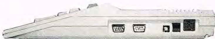
På PC 128s ene side findes bl.a. Reset-tasten, Joystick-port 1 og 2 m.v.
