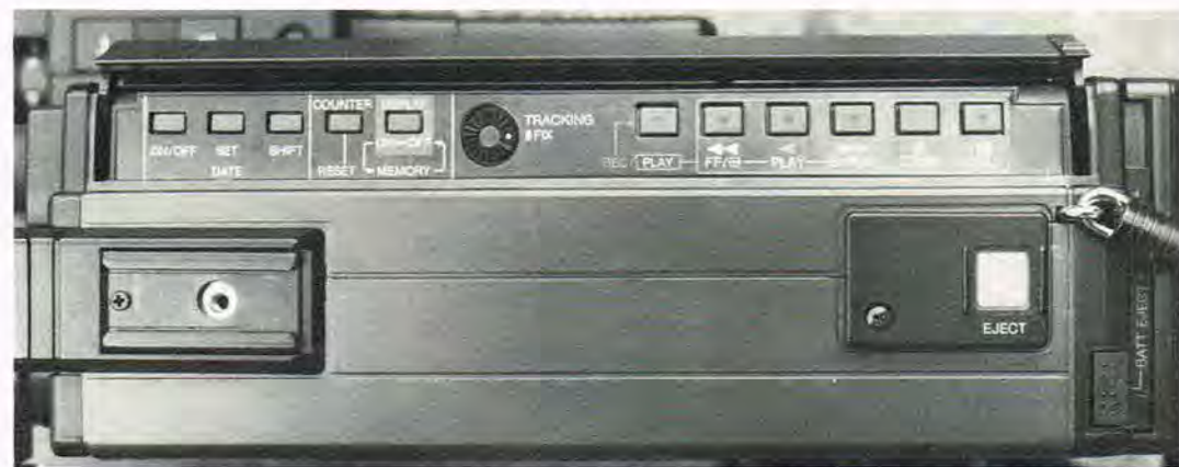
En klap foroven på kamera-optageren afslører et komplet kontrolpanel for videobåndoptageren. Der mangler ikke noget. Endda tracking, memory, stillbillede og datoindstilling er der mulighed for at betjene herfra.
