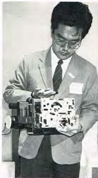
Mr. Kitagawa fra Panasonic demonstrerer hvordan der er blevet plads til aluminiumchassiset i en VHS Movie. Den stabile og lette chassisstype har Panasonic bibeholdt trods den noget dyrere fremstillingsproces.
