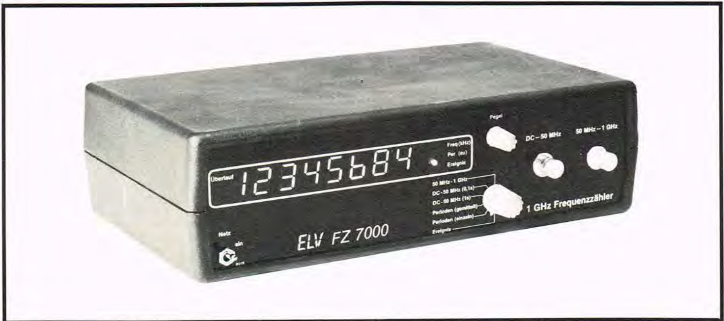
Den færdige frekvenstæller med de to indgangsbøsninger (DC-50 MHz) og (50 MHz-1 GHz). Funktionsvælgeren med 6 positioner og over denne potentiometer for niveauindstilling. Helt til venstre er lysnetafbryderen.
