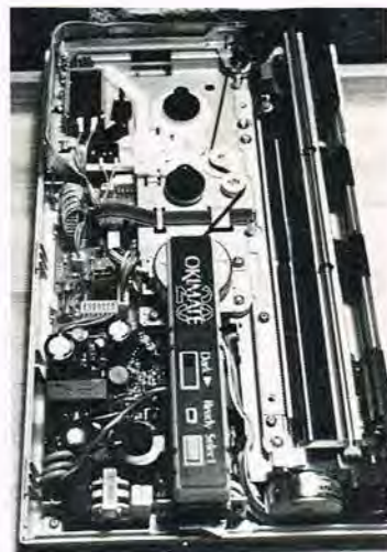
Okimate 20 er simpelt opbygget og næsten støjfri drift.
