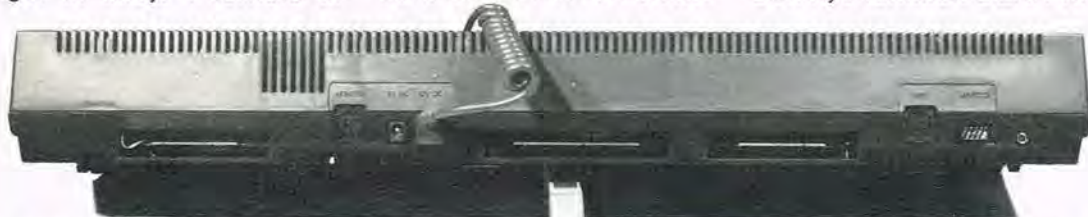
Der er mange I/O porte på CPC 664. Fra højre er der et stereo udtag, ét joystick, kassettestik, Centronic-parallel printer, udvidelses-porte, 12W/DC, 5W/DC, monitor udgang samt disk-drev nr. 2. På siden er der desuden lydregulering.
