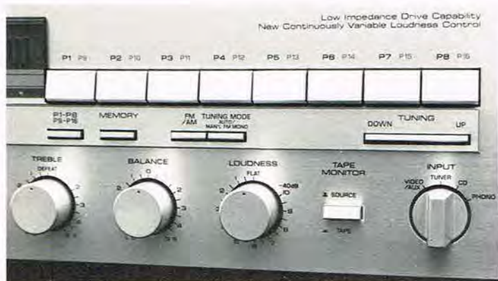
På dette foto af R-5 receiverens højre del ses preset knapperne til forvalg af de 16 AM/FM stationer, de øvrige funktionsknapper til tunerens, samt tonereguleringer og indgangsvælger.
