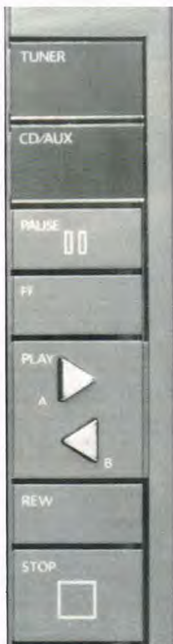
Det lodrette betjeningspanel, der er vist her, har øverst funktionsknapper for indkobling af tuner og CD/AUX, og underneden findes betjeningsknapperne for båndoptagerens løbeværk. Panelet afsluttes med en mikrofonindgang.
