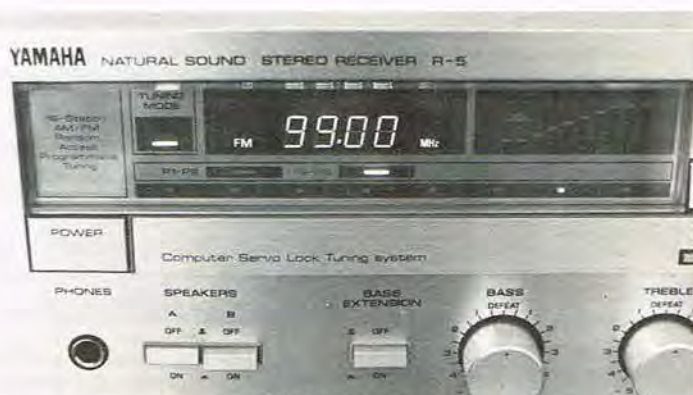
Display'et med den tydelige frekvensangivelse. Højre halvdel af dette kan vise signalstyrken. Af specielle funktionsknapper ses Bas Extension, der er omtalt i artiklen.
