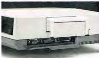
Kontakter på bagsiden af computeren for tilslutning af ekstra disket-enhed, Centronics parallel skriver eller RS 232C, printer eller modem.
