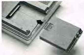
Guldbelagt ekspansionskontakt gør det muligt at tilkoble enheder som f.eks. modem, faste programmer og så videre.
