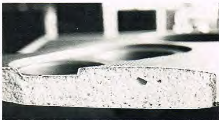
Her ses frontpladens sandwich-konstruktion.
