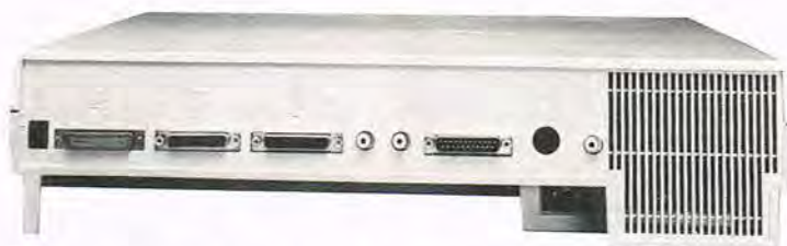
Bagsiden rummer alle nødvendige ind- og udgange. Bemærk tre former for 'video' -udgange og stereo.
