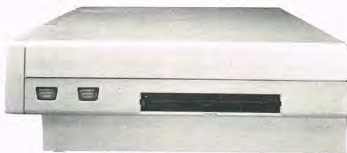
På højre side sidder de to joystick/mus-indgange sammen med en ROM-indgang.
