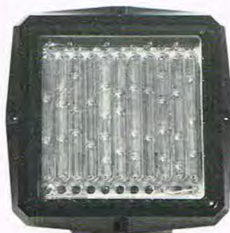
De enkelte enheder er opbygget med 11 magneter og med hver sin svingspole fastgjort i den flade plastmembran.
