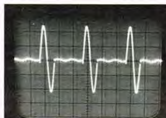
Vi ser her en enkelt Burst periode med en pause svarende til 2 perioder.
