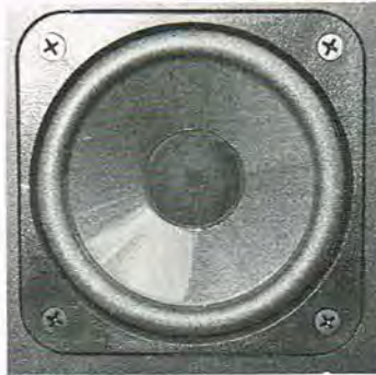
Mellemtoneenheden er opbygget uden eget kammer, men med lukket bagside.
