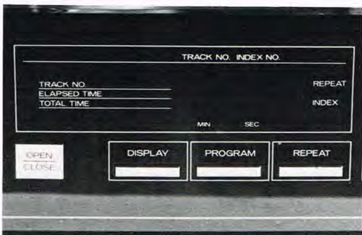
Under displayet ses knapperne for Display, Program og Repeat. Førstnævnte skifter mellem displayets tidsudlæsning. Programknappen aktiveres når melodierne skal gemmes og sidstnævnte gentager melodierne.
