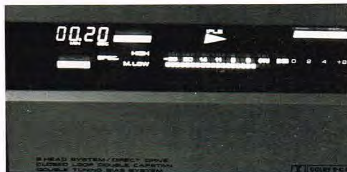
Displayet giver alle nødvendige informationer, og via udstyringsmeteret er det let at foretage en finindstilling med den manuelle bias-justering.
