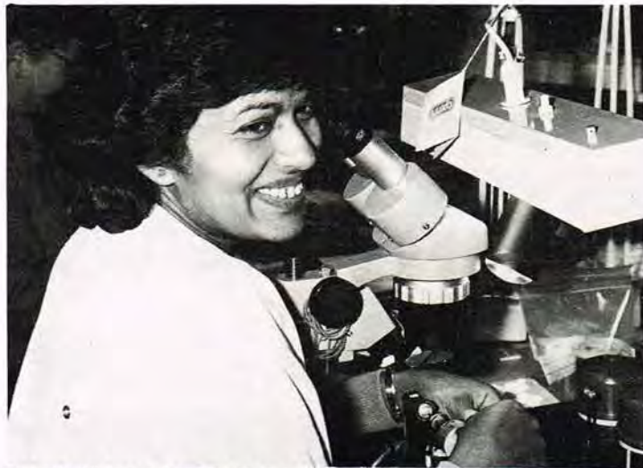
Det er små sager, der arbejdes med i en moving coil produktion, så der må anvendes mikroskop, som det ses her foran den glade Ortofon pige.
