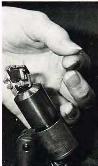
Tråden, der håndvikles på en moving coil pick-up, er så tynd, at den ikke engang kan ses på dette nærfoto.
