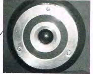
Her ses pyramide højtalerens øverste del. I selve den drejelige trækugle er monteret en D2008 diskant-enhed, og nedenunder ses M13 præsens-enheden (høj mellemtone). Begge Scan Speak fabrikat.
