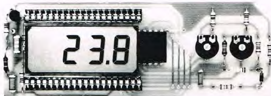
Det færdigmonterede print med displayet set mod bestykningssiden.
