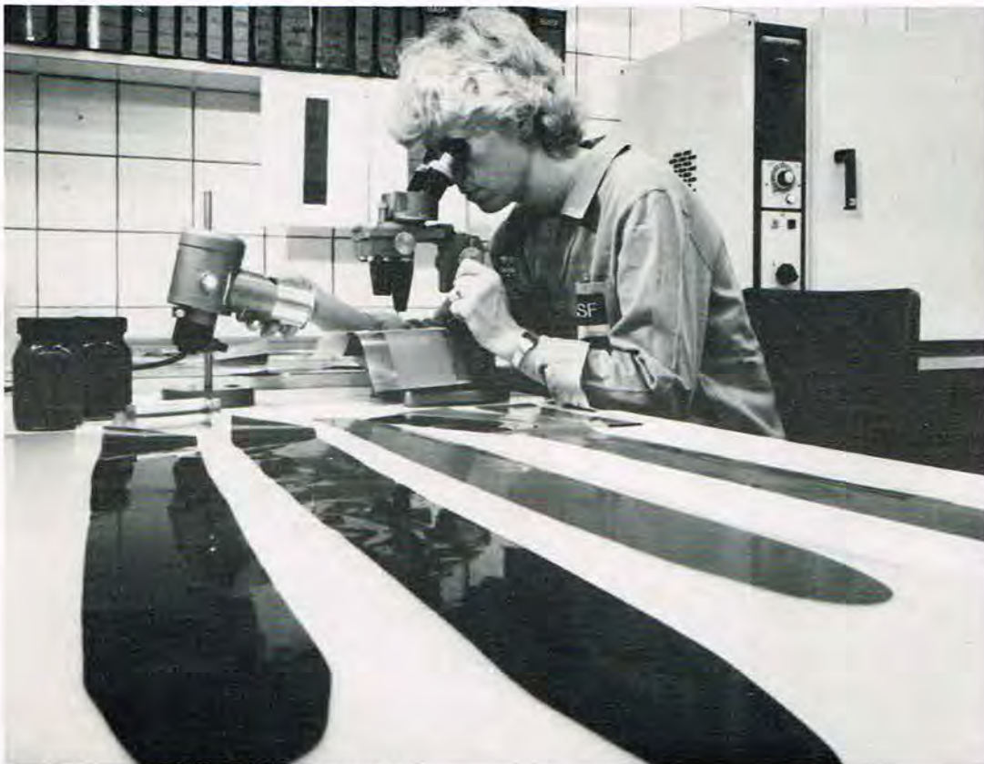
Her testes coatingen på den magnetiske film.
