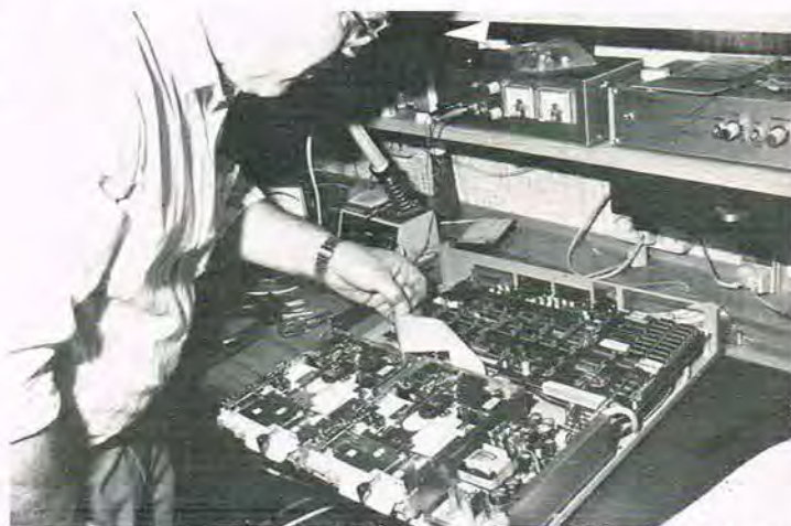
Hele systemet er samlet, men endnu mangler BUS-forbindelserne fra koret til de to diskstationer.
