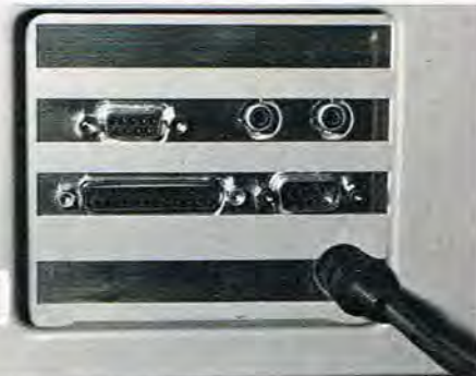
På bagsiden finder vi en parallel og en seriel port, joystick-port, samt en audio, en video composite og en RGB-video udgang.
