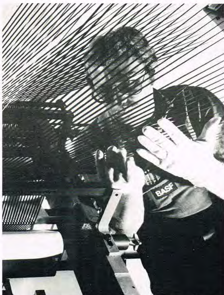
Det er præcisionsmaskiner, der på BASF's store båndfabrikker skærer den magnetiske film ud til magnetisk tape. Nøjagtigheden er 1/100 mm.
