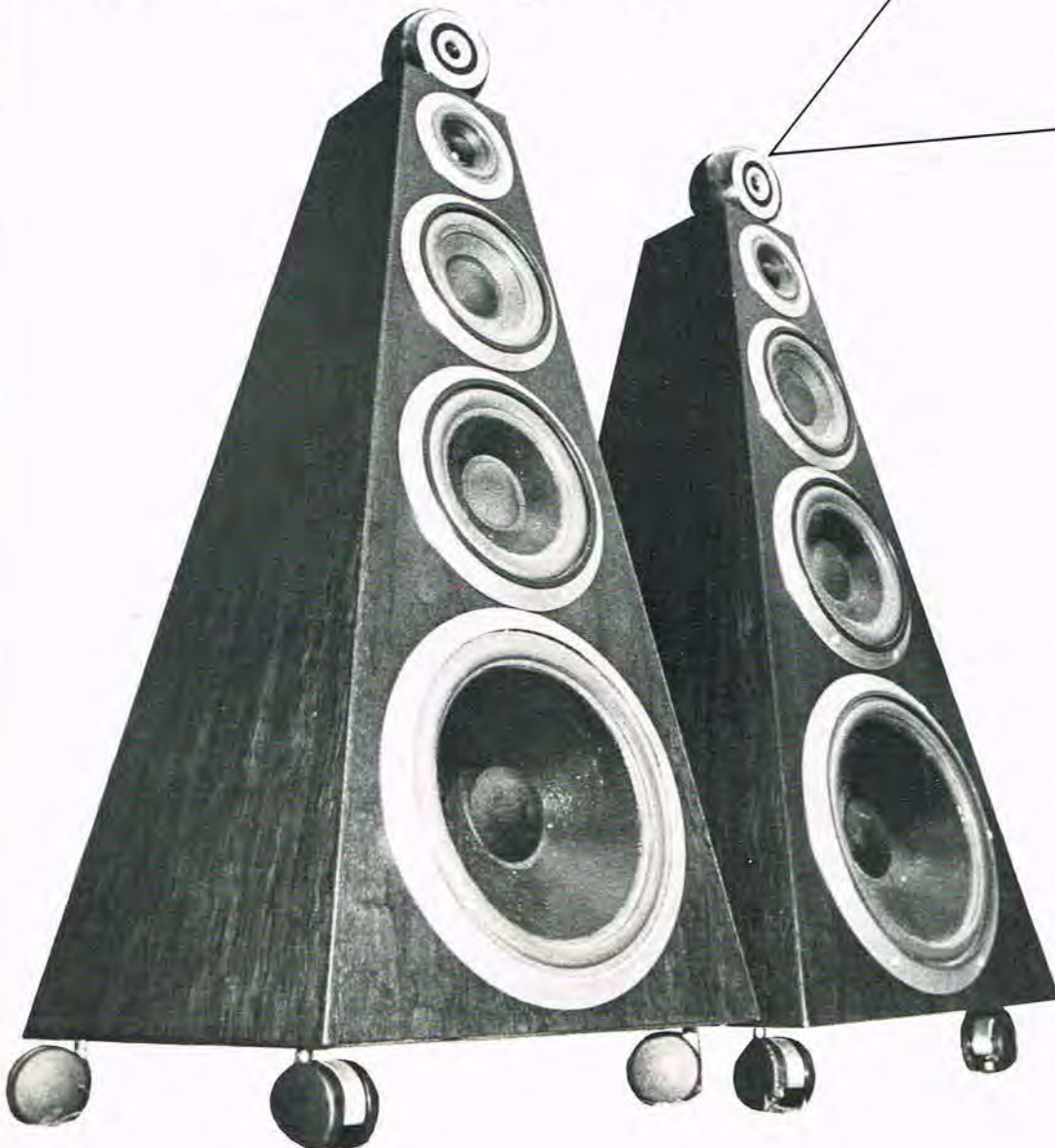
Trækuglen, der indeholder diskantenheden, er et stykke modelsnedkerarbejde af højeste kvalitet. Problemet har blot været at finde massivt træ i de forskellige træsorter til at dreje kuglen af.
