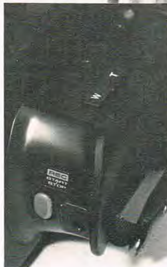
Samtlige betjeningsknapper til kameradelen sidder overskueligt anbragt på venstre side, mens start/stop knappen sidder i håndtaget på højre side, som vist her.
