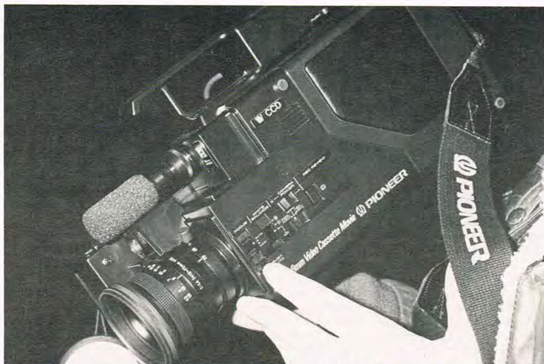
Samtlige betjeningsknapper til kameradelen sidder overskueligt anbragt på venstre side, mens start/stop knappen sidder i håndtaget på højre side, som vist her.
