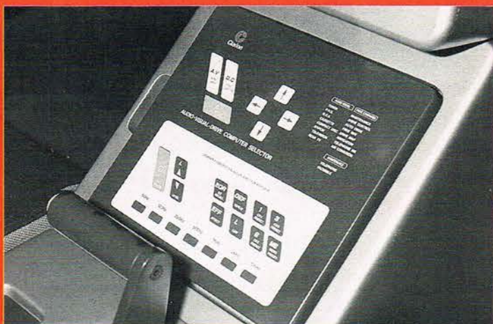
Her er et nærbillede af computerens betjeningspanel. Alle informationer overføres direkte til den farve TV monitor, der er indbygget i instrumentpanelet.
