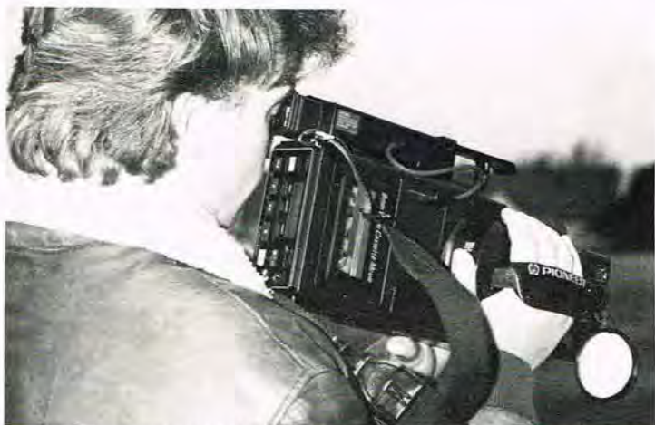
Den elektroniske søger kan placeres i forskellige positioner på camcorderen. I dette tilfælde sidder den som på et småfilmskamera. Forrest ses det hvide dæksel, der bruges ved indstilling af hvid-balancen.
