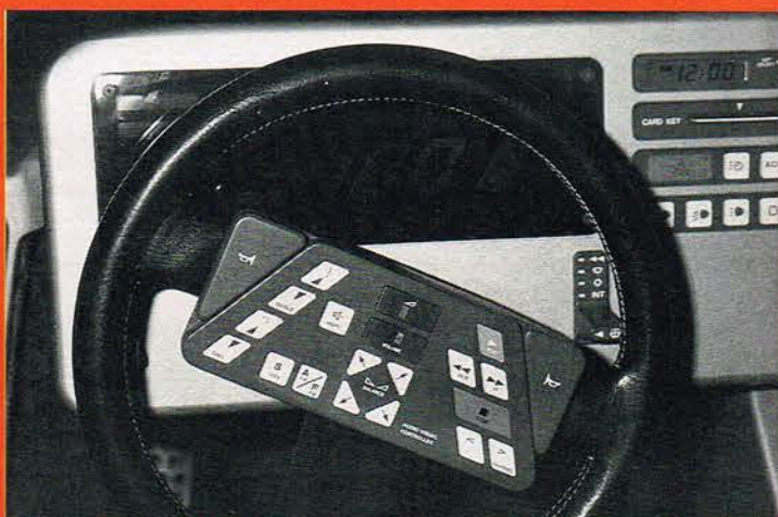
I denne Clarion bil betjenes autoradio, kassetteafspiller, 8 mm PCM lyd-giver, video m.v. ved hjælp af disse taster på rattet.
