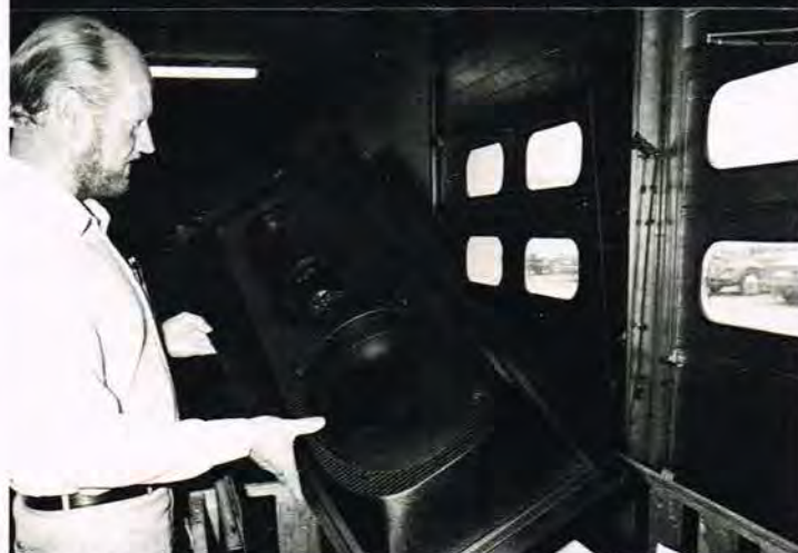
Frontpladen fremstilles ved en såkaldt sandwich-proces, hvor et specielt 'dødt' materiale under stort tryk er støbt ind mellem to lag vacuum-formet slagfast polystyren. På billederne ses en sådan polystyrenplade, samt et tværsnit af den færdige konstruktion.
