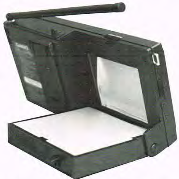
Et specielt 'backlight' modul, der her ses slået ned på TV-1000 farve TV'et, giver forbedret lysintensitet
