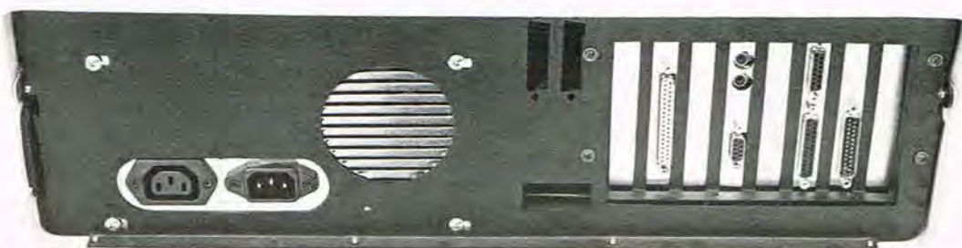
Bagsiden mangler ingen væsentlige udgange. Selv en udgang for composite video og en RF-tilslutningsmulighed er med (uden modulator). Der er RGB, parallel, RS232, game adapter, tastaturstik og både ind og udgange for strøm.
