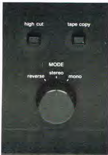
Harman Kardon er en af de få producenter, der har bibeholdt en stereo/mono omskifter med reverse funktion. Den ses nederst til højre.
