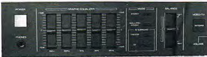
På venstre side af fronten på AV-C10 ses dens 5-bånds equalizer. Til højre herfor er knapperne for stereo, simuleret stereo, surround-lyd samt balance.
