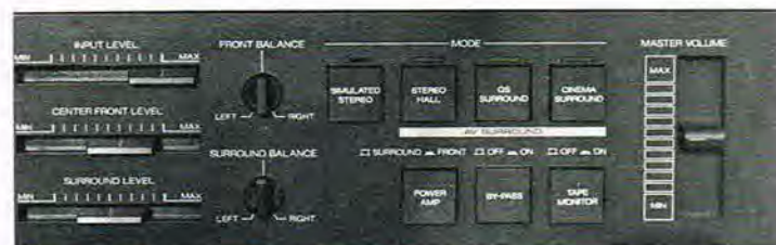
Højre del af fronten på A/V Surround Processoren DS-77 med bl.a. knapperne for simuleret stereo, samt de tre surround lydssystemer Stereo Hall, QS-Surround, og Cinema Surround.
