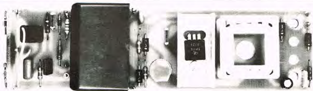
Det færdigmonterede basisprint til stroboskopet.
