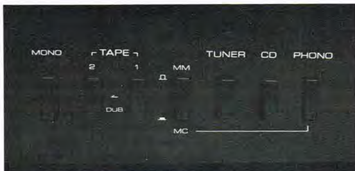
RA-840 BX er en linie-forstærker, helt uden tonekontroller. Derfor findes der kun få betjeningsknapper. Udover de viste er der kun volumenknappen. Volumenknappen fungerer også som balancekontrol.
