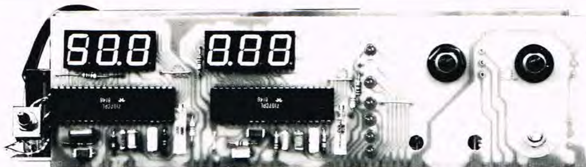
Det færdigmonterede indikatorprint uden kabinet set mod komponenterne.
