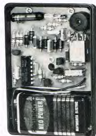
Den færdigmonterede tæller med batteriet placeret i kabinettet.
