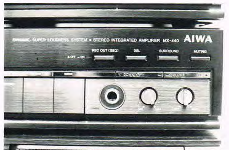
Højre halvdel af forstærkeren med knapperne for REC. Out, DSL (øget bas), Surround lyd, og muting. Nederst ses mikrofon indgangen med mixer mulighed.
