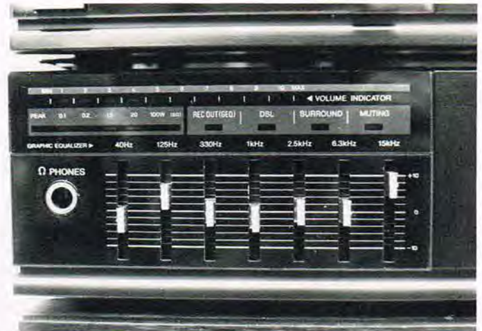
Forstærkerens indbyggede 7-bånds grafiske equalizer dækker et område på \pm 10 dB.
