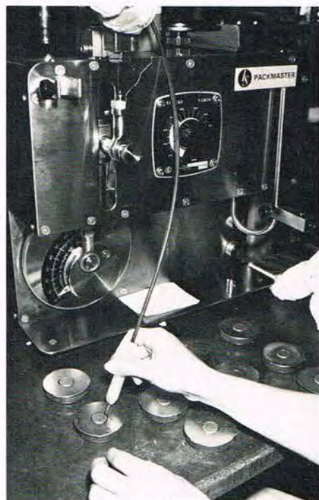
Dette anlæg påfylder ferrofluid (magnetisk olie) i nogle af magnetsystemerne. Olien sikrer en højere effekt kapacitet ved at køle spolen.
