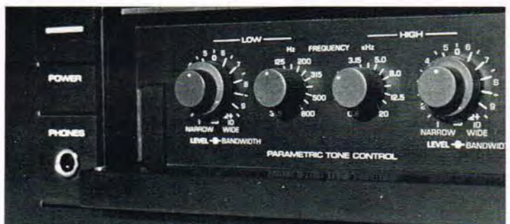
Fra venstre halvdel af det sekundære betjeningspanel på C-85 kontrolforstærkeren, ses her båndbredde kontrollerne og den parametriske tonekontrol med de mange muligheder.
