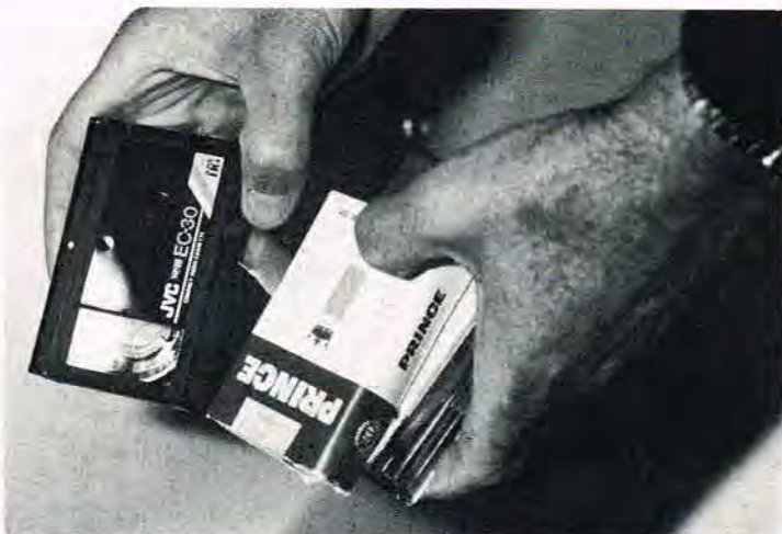
Den lille VHS-C kassette giver 30 minutters spilletid på standard hastighed, og 60 minutter på halv hastighed (Long Playing).
