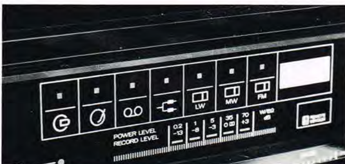
Alle funktioner, der vælges på forstærkeren, vises tydeligt med en lysmarkering ud for symbolerne. Lige under er der udstyringsmetre for udgangseffekt og optagelse.
