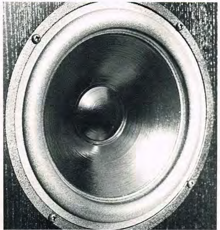
Bassen i en KT-Prisme varetages af en 8" SEAS-enhed med plasticbehandlet membran.
