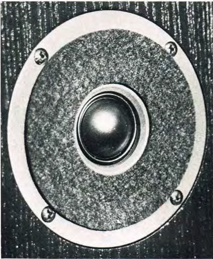
Den 1" store dome-diskant er et kapitel for sig. Det er nemlig den samme Vifa-enhed som F3/lyd har fået udviklet til deres nyeste produkter. Enheden har bl.a. fået monteret et lille kammer bag membranen for at kontrollere dens udsving.
