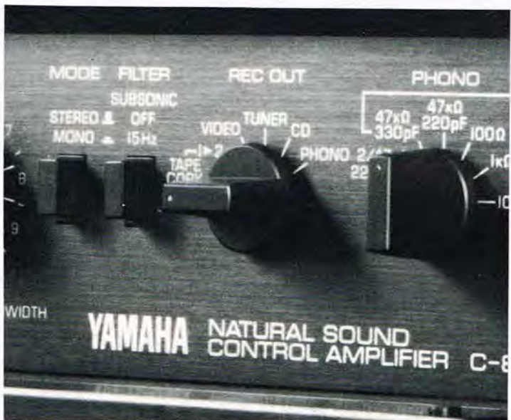
Fra højre halvdel af det sekundære betjeningspanel på C-85 ses her omskifterne for Phono (mange muligheder), Record out, samt omskifterne for mono/stereo og subsonisk filter.
