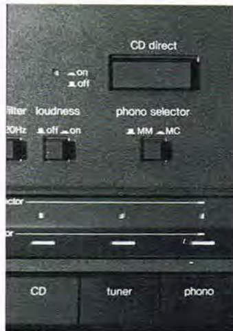
Store overskuelige reguleringer, - fortrinsvis i den klassiske drejeknap - udførelse, der giver en helt præcis indstilling, er kendetegnende for Technics SU-V60 forstærkeren.
