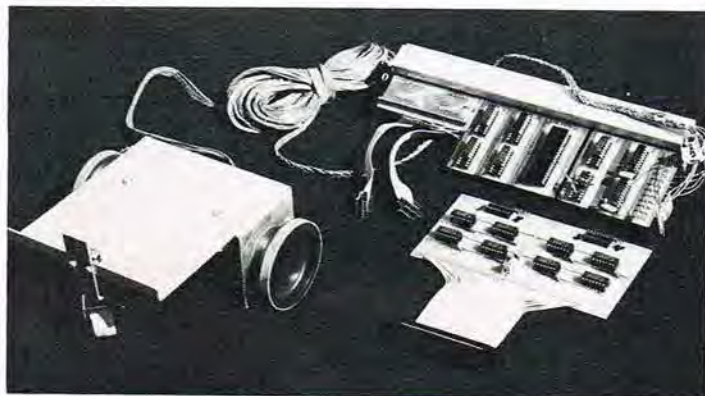
Nederst: Det store print, der udgør overgangen mellem computer og port. Ovenover ses selve porten, fra venstre det lille print, de fire kredse til add. logik, Z80-pioen, kredsene til styring af stepmotorerne. T.v.: Skildpadde opbygget som vist på skitse.
