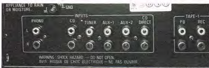
På tilslutningssiden har Denon PRA 1100 bl.a. to AUX og to CD-indgange. Den ene CD er en CD-Direct.
