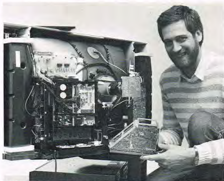
Bjarne Andreasen - projektleder på Beosatprojektet - med indbygningsmodul Beosat LX, som er beregnet for indbygning i Beovision L og LX modellerne. På billedet ses den første operationelle prototype.
