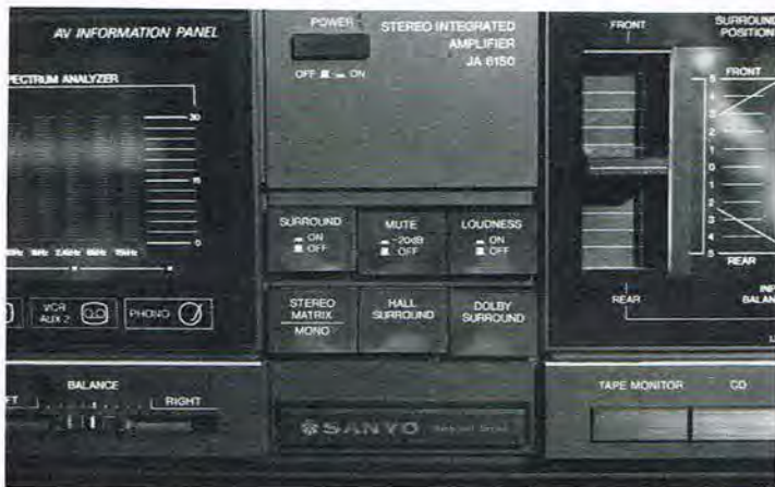
Stereo Matrix, Hall Surround, Dolby Surround, - alle surround systemerne ind- og udkobles på forstærkerens midterpanel.
