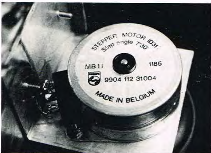
Undersiden af skildpadden, hvor den ene af de to steppmotorer ses, da de udvikler ret meget varme, er de monteret direkte på skildpaddens aluminiumstel, hvilket giver en god afkøling.
