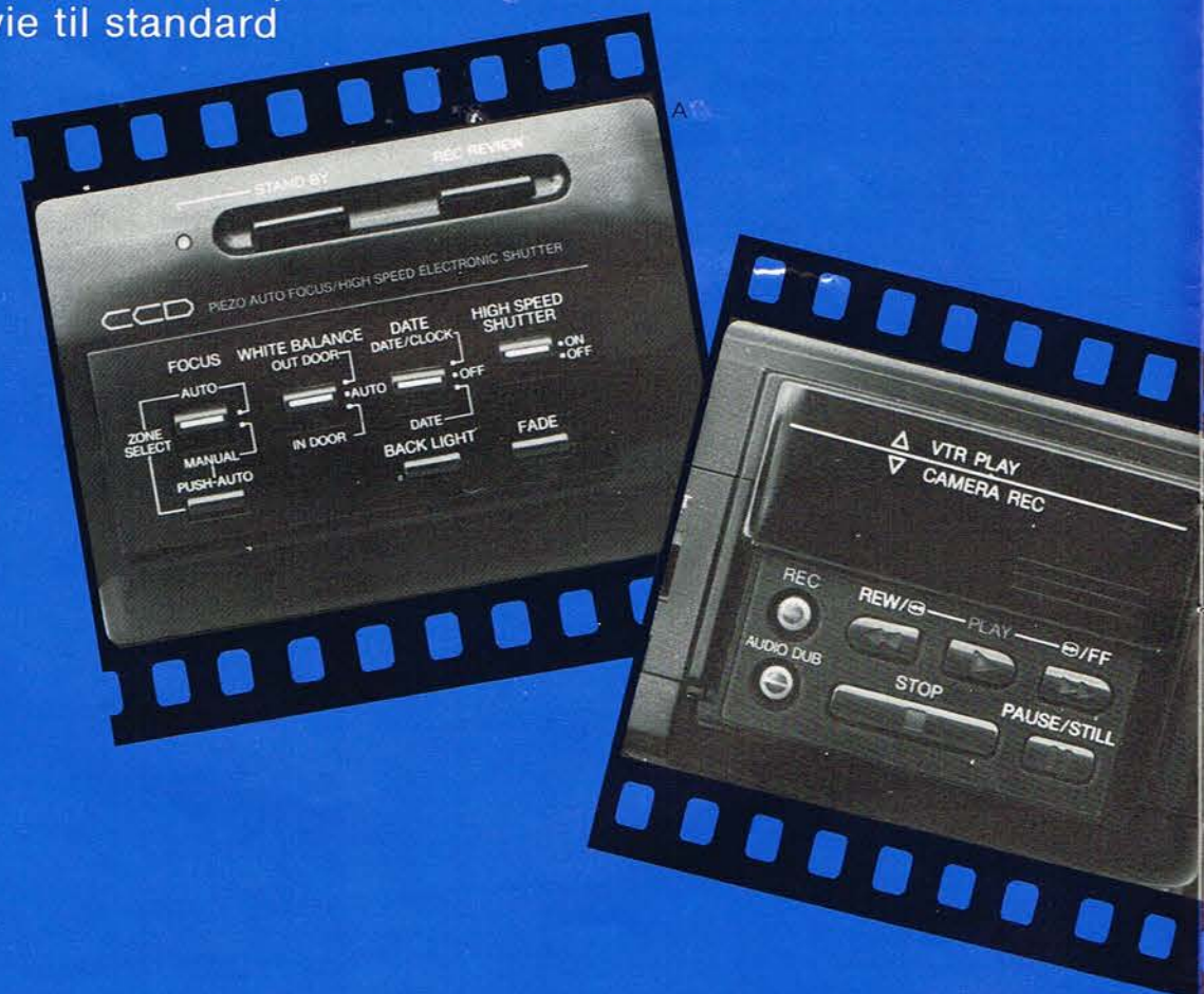
A. Kontrolpanelet foran, der styrer kamerafunktionerne. Flere indstillinger kan både styres automatisk og manuelt. B. Her ses betjeningen af videobåndoptageren bagest på kameraet, der når kameraet betjenes, er dækket af en acrylplade, der også fungerer som omskifter. C. Det lille firkantede 'vindue' til venstre for objektivet er sensoren for den automatiske hvidbalance-indstilling.
