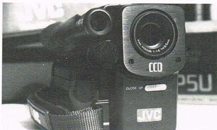
Et fast vidvinkelobjektiv på 9,5 mm sikrer stor dybdeskarphed under de fleste lysforhold, - uden indstillinger af nogen art.
