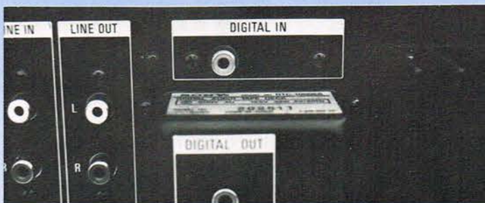
Færdig indspillede DAT-bånd og CD-plader er indspillet med en samplingsfrekvens på 44.1 kHz. Hvis man forsøger at kopiere på denne frekvens via den viste digitalindgang på en DAT-båndoptager, vil et kredsløb blokere indspilningen, og en indikator fortælle at det, der ønskes indspillet, er kopi beskyttet. I så tilfælde skal indspilles via Line in.
