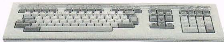
Tastaturet er bestykket med 101 taster som fordeles på det almindelige tastatur, et numerisk tastatur, separate piletaster samt Insert, Home, Page up, Page down, Delete og End.
