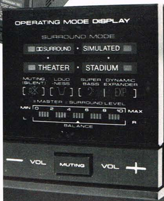
Alle funktioner indikeres på displayet. Det gælder surround indstilling, loudness, super bass, muting, expander og styrke/balance.
