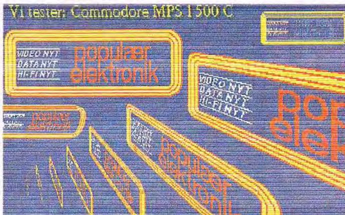
Bemærk her at MPS 1500 C har så mørk en toning, at skygger udvaskes og der er desuden overlæg mellem de enkelte farvebaner.
