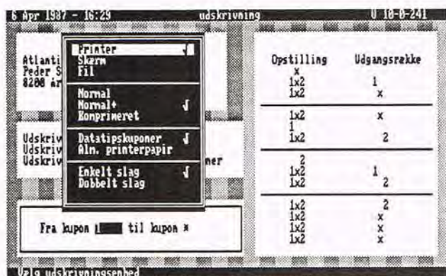
Så mange forskellige udprintningsformer er der. Læg mærke til, at man bl.a. kan køre med dobbelt anslag, hvis farvebåndet er lidt slidt.
