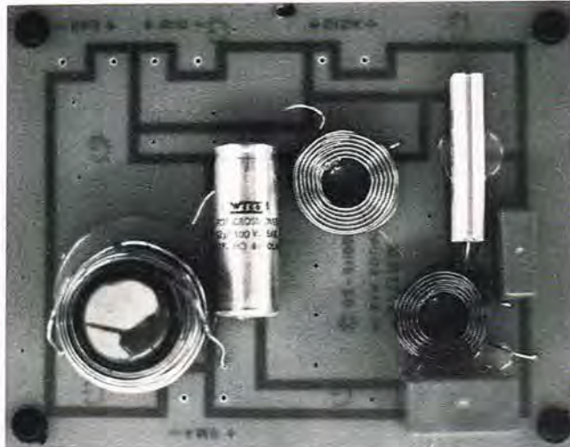
Her ses det enkle men effektive filter til system Five. Bemærk de kraftige komponenter og kobberbaner.
