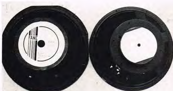
Set oppe fra fremgår forskellen i magnetstørrelse på basenhederne klart.
