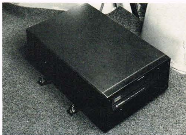
Pioneer Multi-Play System. CD afspilleren, der f.eks. kan stå i bagagerummet, kan indeholde 6 CD plader i magasinet.
