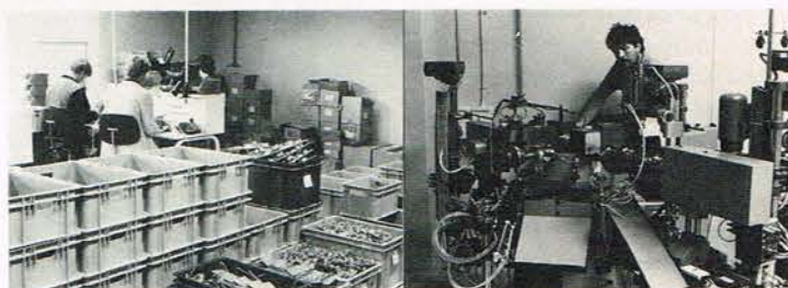
Egenproduktion af delefiltere sikrer at kvaliteten bliver præcis som krævet. Man vikler også selv luftspolerne. Til visse spoler anvendes LC-OFC kobbertråd.
