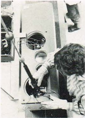
Montering af delefiltere i en Dali 18.
