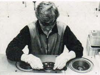
Omhyggelig placering af dæmpe-materiale i en Dali 18.
