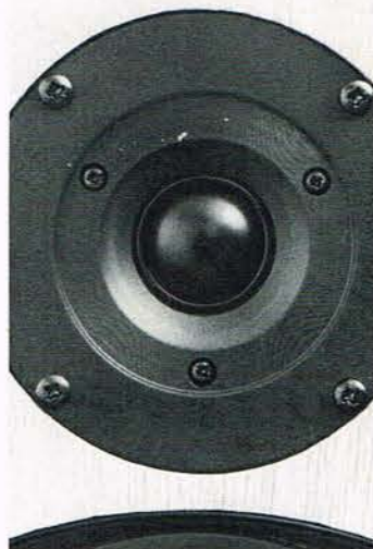
Diskanten håndteres af en 1" dome af skandinavisk oprindelse.
