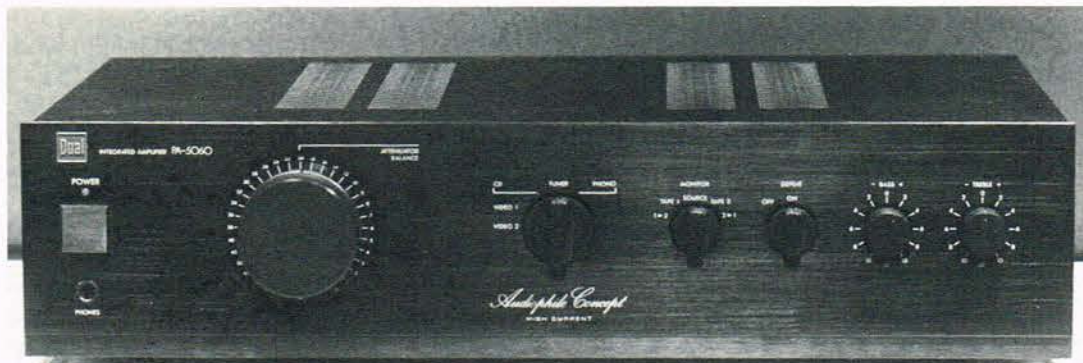
Sort, ret tung og enkelt opbygget, omend intet savnes, siger Niels Nørby om Dual PA 5060 forstærkeren, der yder 2x60 watt i 8 ohm.
