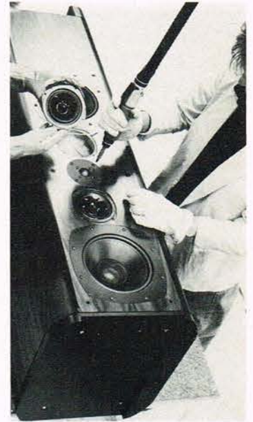
En Dali 40 kan ikke monteres på samleband. De monteres individuelt af små selvstyrende grupper, der i fællesskab samler og pakker dem - een efter een.
