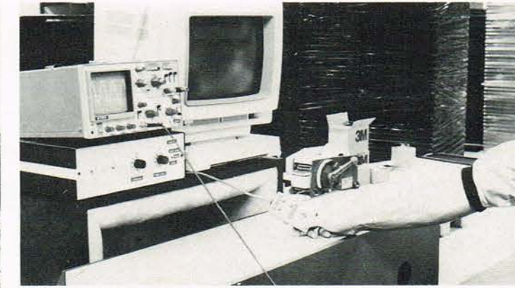
Alle højttalere testes efter samlingen.
