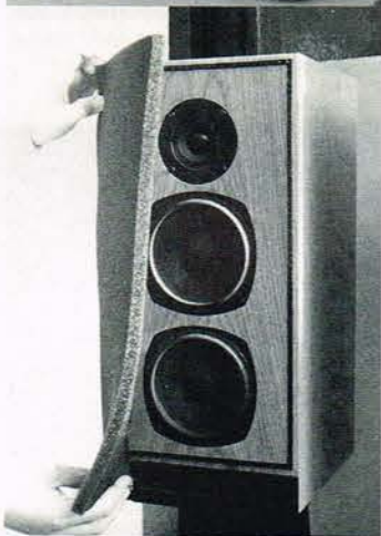
Alt er gennemført til mindste detalje. Her ses skumfronten med de nødvendige fordybninger. Et let tryk får den til at hæfte på den viste kantramme.
