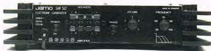
Bagsidepanelet på Jamo SW 50 Electronic Subwoofer med volumenkontrol, fasevender, regulering af delefrekvens, hovedafbryder, nettilslutning, samt tilslutning for forstærker og eventuelle sidehøjttalere.
