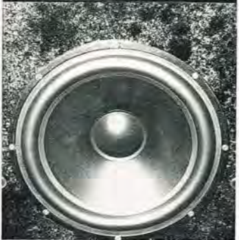
Højttaleren er bestykket med en 2,5 cm diskantenhed med polyamidmembran, en 13 cm mellemtone, samt en 25 cm bashøjttaler, - ligeledes med polyamidmembran. Alle fra den norske SEAS-fabrik.
