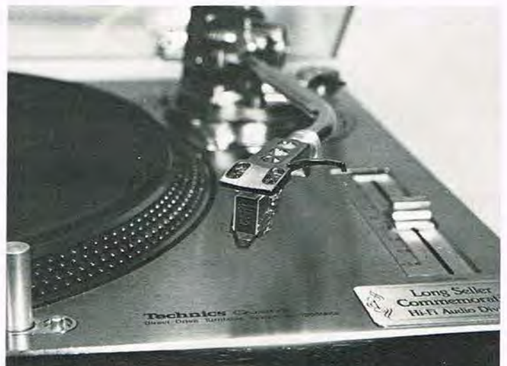
Den S-formede tonearm har standardfatning for lynhurtig pick-up-skift.
