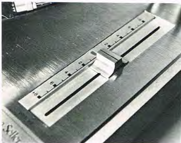
Pitchjusteringen er en skyder med ekstra lang vandring og klik-mærket nulstilling.
