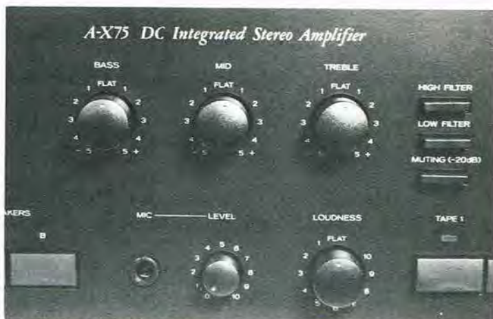
Teac A-X75 forstærkeren har mangleaffinements. Her ses bl.a. tonekontrollerne, der også har fået en mellemtone-regulering.
