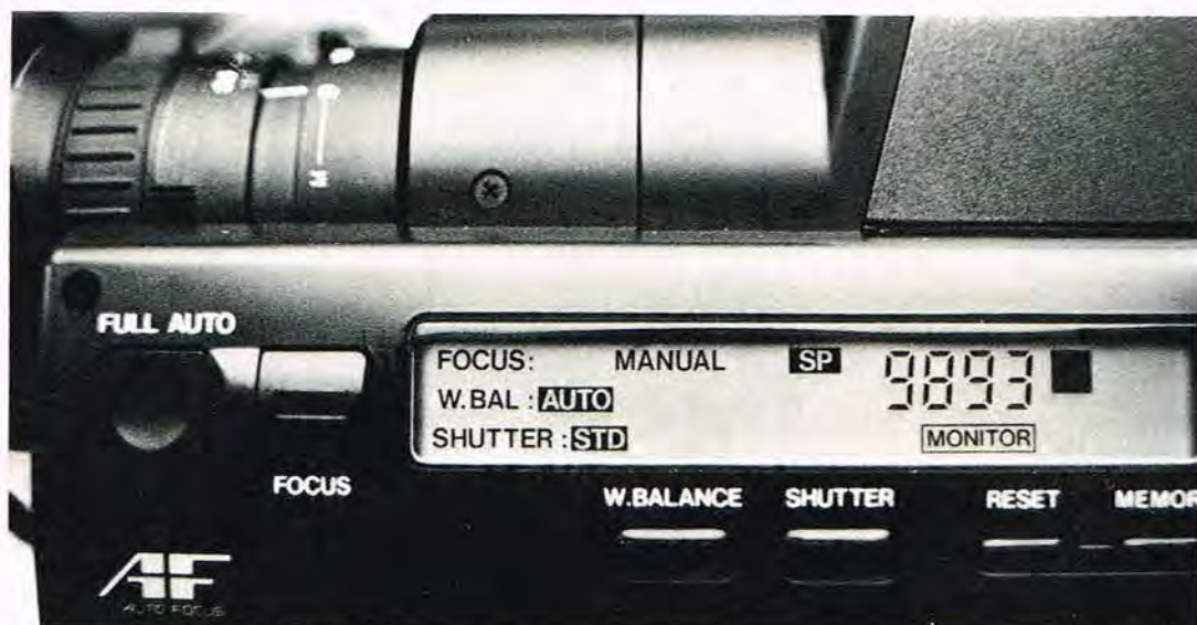
Det store display på venstre side giver et hurtigt overblik over GR-45's hovedindstillinger. Manuel indstilling indkobles via funktionstasterne ved siden af displayet.
