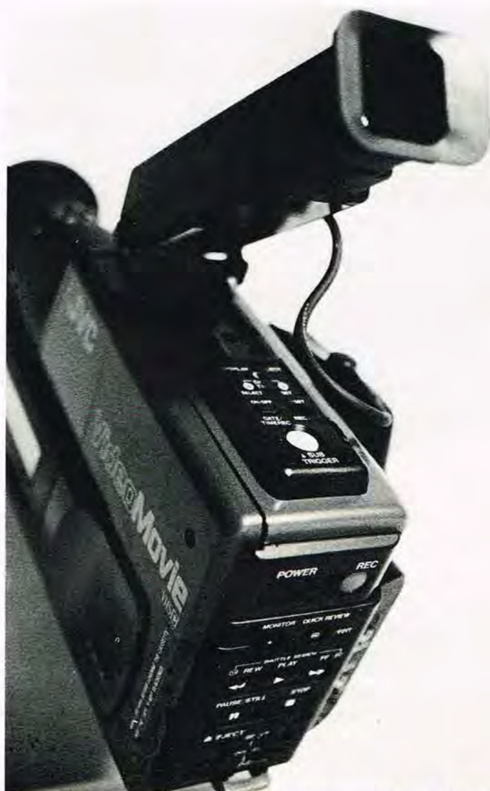
En smart detalje er den ekstra start/stop knap under søgeren til brug ved optagelser fra lavt standpunkt. Bemærk også det store funktionspanel bagpå apparatet.
