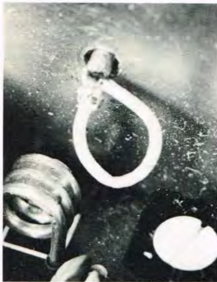
Senserspølen anbringes i nærheden af oscillatoren.
