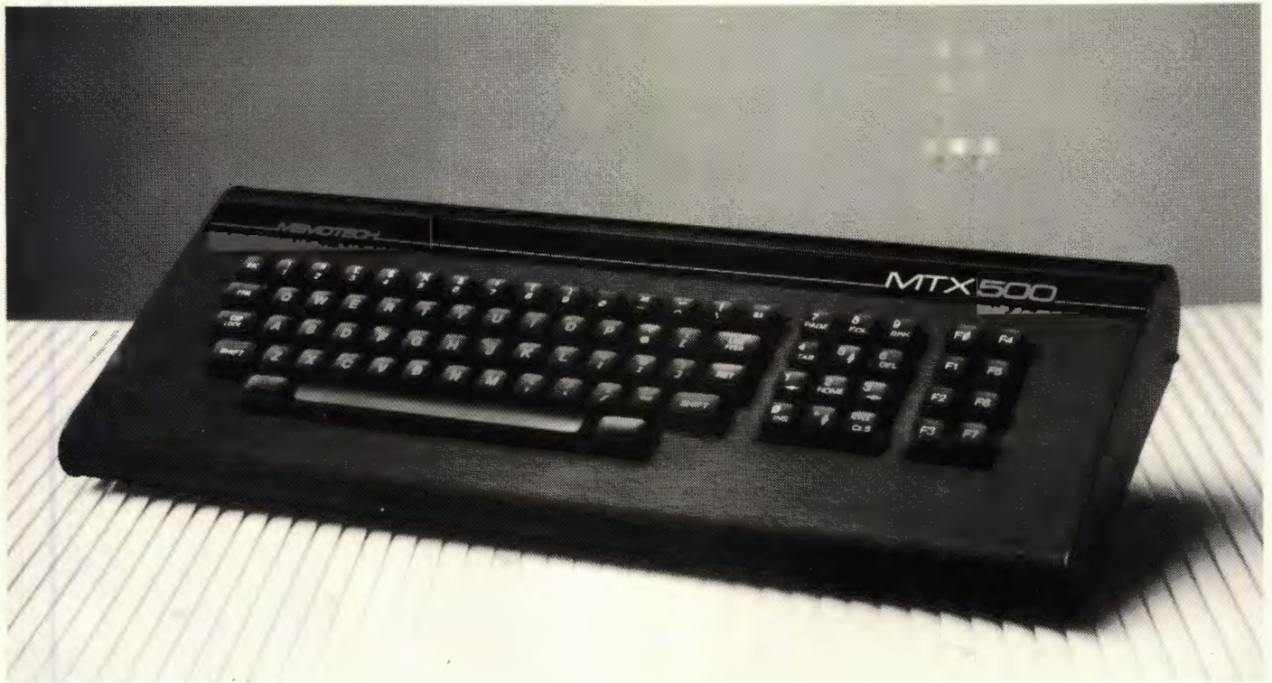
Tastaturet, der er af skrivemaskinestandard og understøttes af en 1 mm stålplade, har separat numerisk tastatur med markørfunktioner og separat funktionstastatur. De to ubeskrivne taster på hver side af mellemrumstangenten laver reset, men kun hvis man trykker på begge på een gang.
