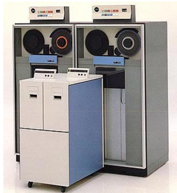
IBM 3420 spole-båndstation contra IBM 3480 kassette-båndstation
